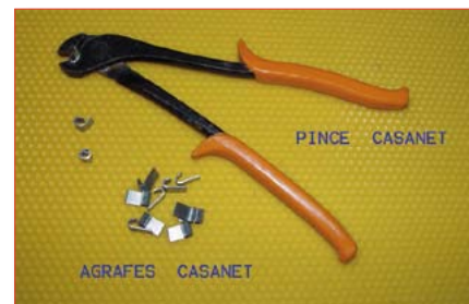
La photo 1 représente la pince et les œillets en alu destinés à assembler les 4 faces de la cage.
