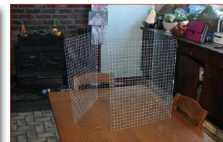
La photo 2 représente les 4 faces en treillis de maille 19mm x 19mm assemblées en position ouverte.
